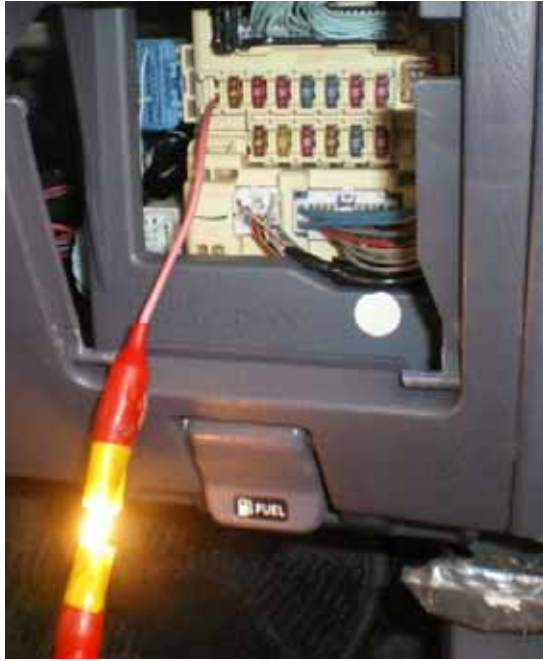
ヒューズボックス側の端子の属性を検電テスターで確認、ノアは下側がバッテリー側
